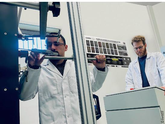
Euradif labo banc ensoleillement porte d'entrée Carpe Diem : menés par Euradif sur ses portes d'entrée, les essais de perméabilité à l'air, de l'étanchéité à l'eau et de la résistance au vent (AEV) permettent d'améliorer les performances des produits face aux agressions extérieures
