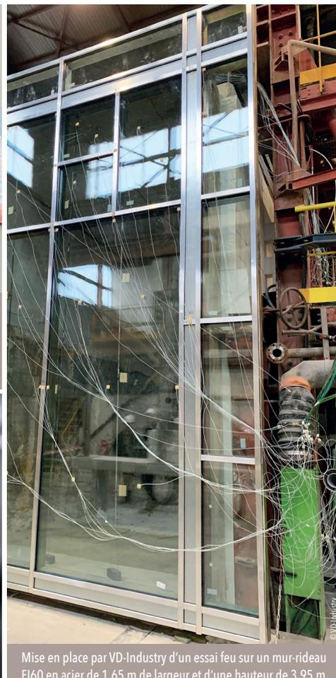
Mise en place par VD-Industry d'un essai feu sur un mur-rideau EI60 en acier de 1,65 m de largeur et d'une hauteur de 3,95 m. Équipé de capteurs, il va être incendié dans un four à brûleurs et devra faire barrage aux très hautes températures
