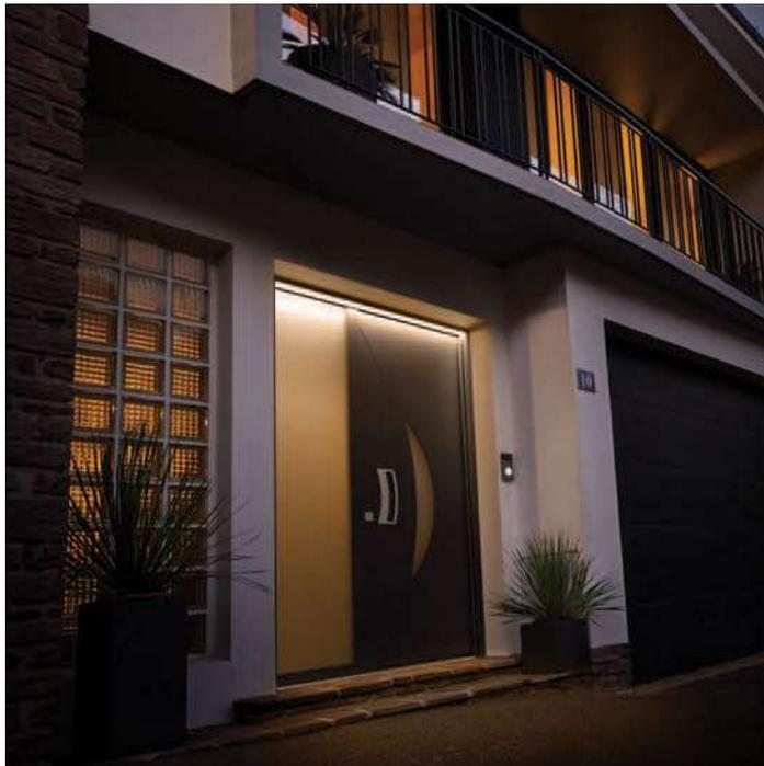
**E**uraled est un système d'éclairage extérieur par bandeau Led pour nos portes d'entrée en aluminium Passage. Le bandeau est intégré dans la tapée de doublage supérieure de la porte avec un minimum de doublage intérieur de 120 mm jusque 180 mm. L'éclairage peut être piloté de deux façons, au choix : soit en version connectée avec l'application smartphone Shelly (Wi-Fi), soit via
