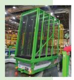
exemple transporter les chevalets entre la ligne de coupe et la ligne de vitrage isolant.
