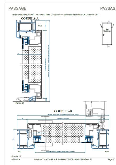
Notre ouvrant monobloc PASSAGE s'adapte à la quasi-totalité des dormants ALUMINIUM et PVC du marché avec une épaisseur allant de 71 à 81 mm.
