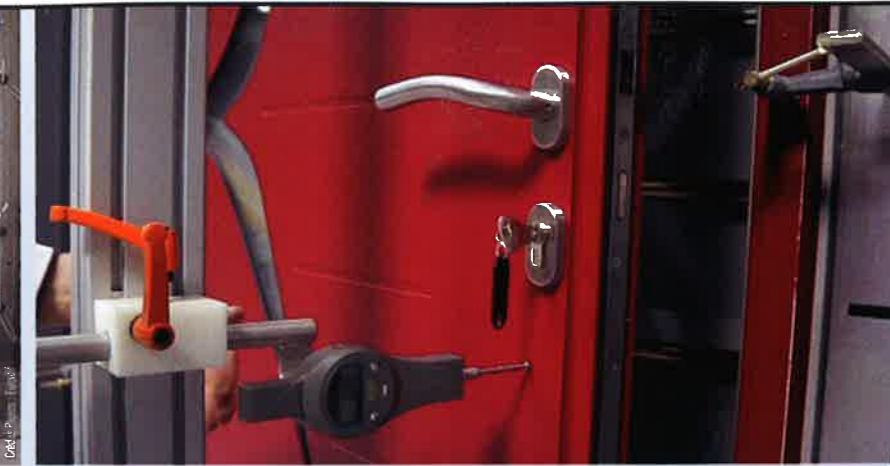
Euradif a récemment intégré un laboratoire unique en son genre avec banc AEV et banc d'ensoleillement au service de ses partenaires
